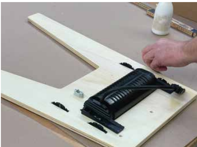
Die hochwertigen Steckdosen werden montiert.
