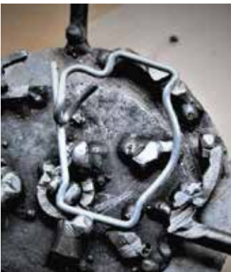
Letzter Feinschliff nach dem Biegen.
